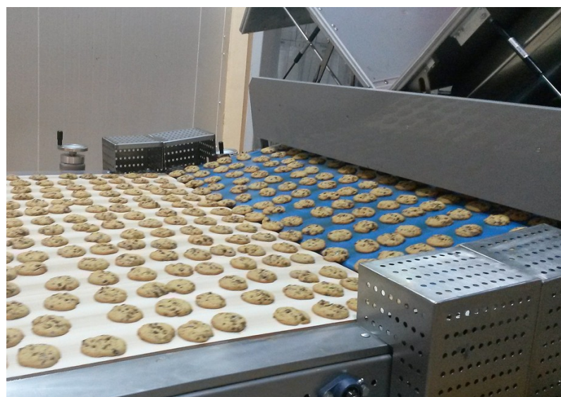
La couche supérieure non traitée de cette bande en tissu entraînée par friction est constituée de PVC ou TPU
