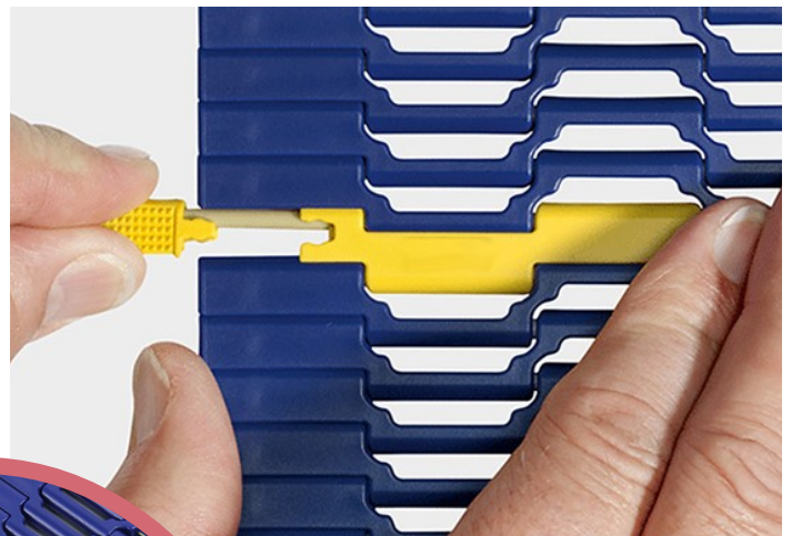
Ce système ergot-charnière limite le temps d'arrêt quand la bande doit être souvent nettoyée
